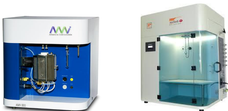
Rys. 1. Urządzenia do pomiarów dynamicznych: sorpcji chemicznej (Altamira AMI – z lewej strony) oraz analizy sorpcji mieszanin gazów i par (mixSorb S firmy 3P Instruments – z prawej strony).
